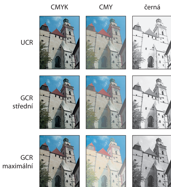
Obrázek 1.18 Metody generování černé – UCR a GCR se středním a maximálním použitím černé
