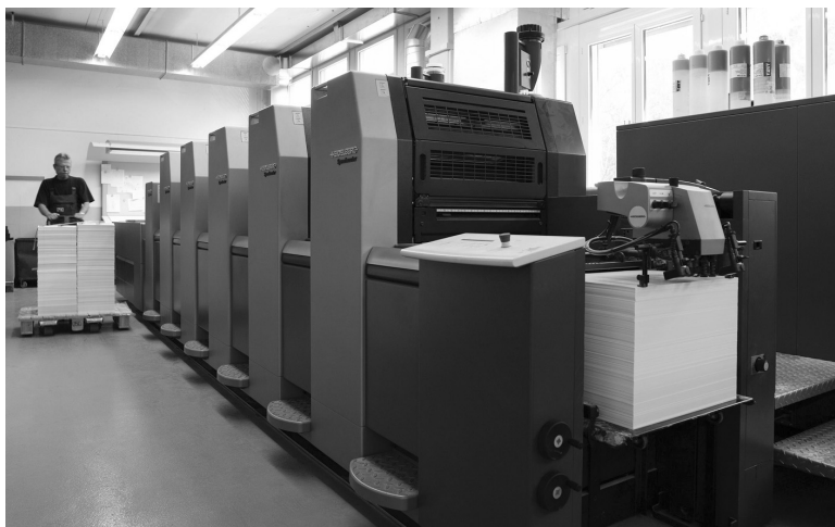
Obrázek 1.24 Tiskový stroj s pěti tiskovými jednotkami a lakovacím agregátem (vzadu). V každé tiskové jednotce se tiskne jedna barva (foto Heidelberg Druckmaschinen AG)
