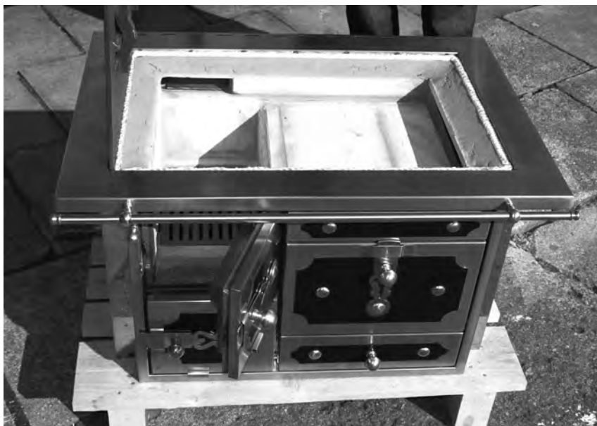
Obr. 6 Pohled dovnitř korpusu na ohniště a troubu
