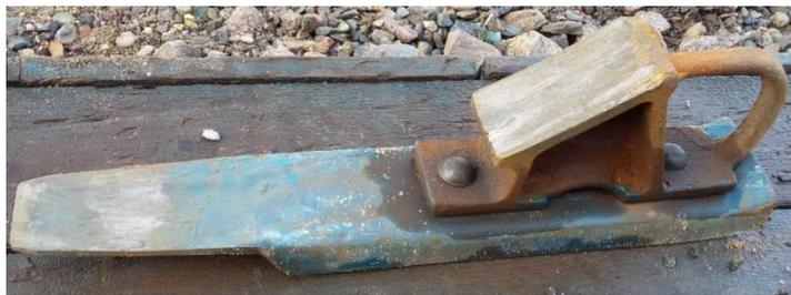
Рис. 7. Внешний вид горочного башмака усовершенствованной конструкции
