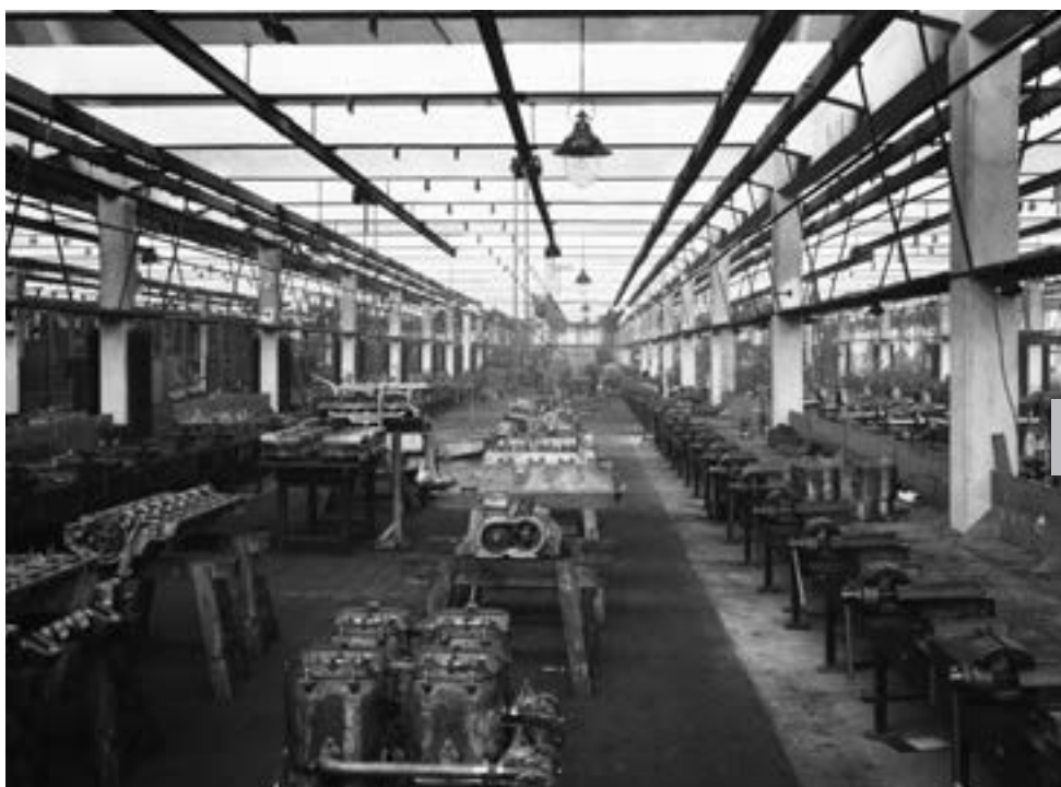
Pohled na montáž agregátů, vpředu čtyřválce lehčího typu traktoru „U“, v pozadí kliková skříň šestiválce „Z“. Bloky válců a hlavy byly pro oba typy společné
