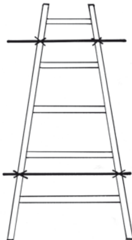
Svislý provizorní rám ze štaflí
