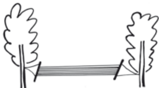
Vodorovný provizorní rám upevněný mezi kmeny stromů
