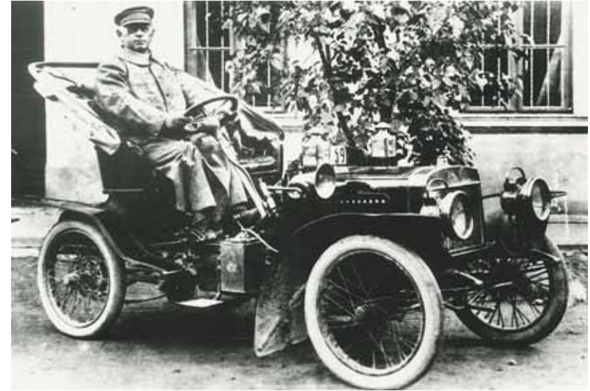
Jeden z prvních vozů s pohonem zadních kol výjimečně řetězem. Takové byly údajně jen tři, další měly spojovací hřídel
