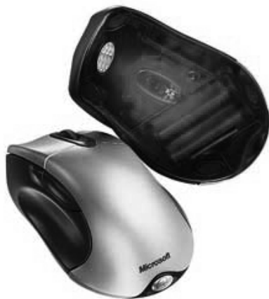
Obrázek 1.5: Optická myš snímá pohyb pomocí červeného paprsku
