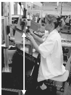
Příliš vysoká pracovní výška Zatížení rukou – chybějí opěrky
