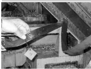
Přetržená oka vnitřního krytování
