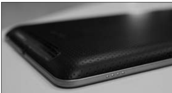
Obrázek 1.4 Dokovací konektor v podobě několika kontaktů
