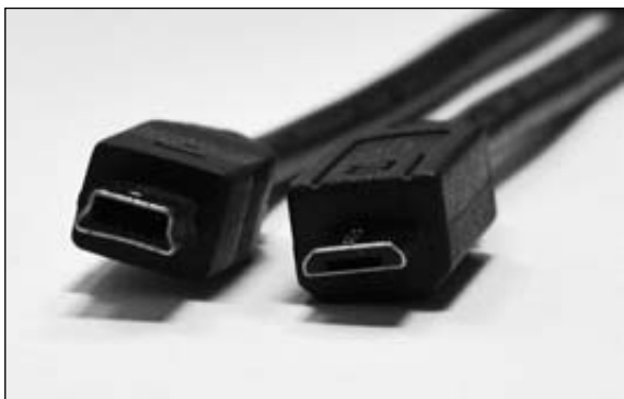
Obrázek 1.3 Konektor miniUSB (vlevo) a microUSB (vpravo)
