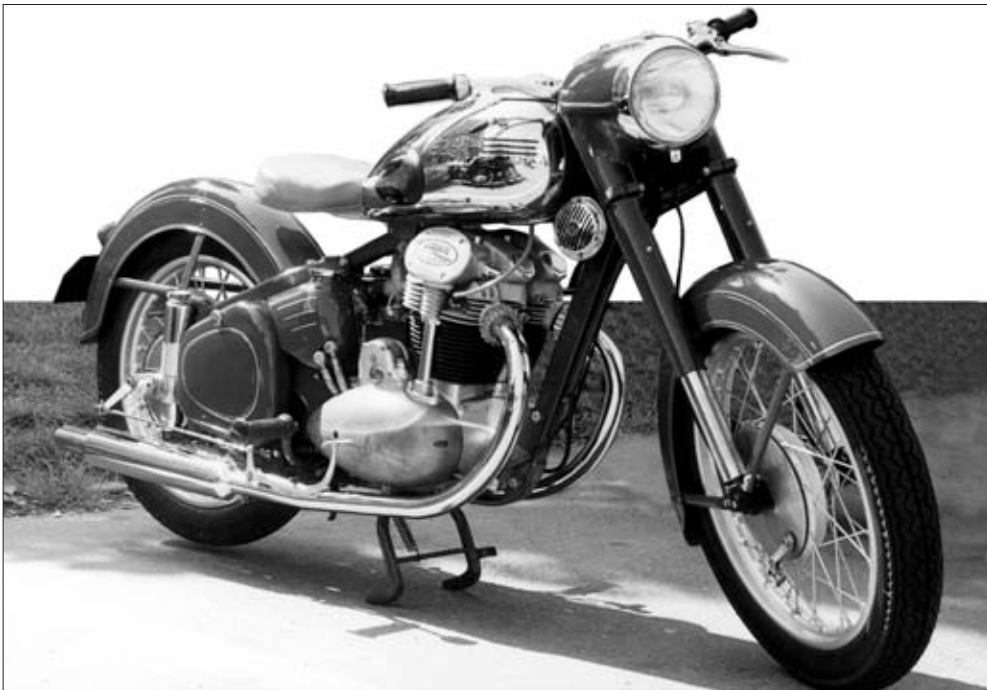
Jawa 500 OHC typ 15/01 s jednosedlem a malými brzdovými bubny byla vyráběna v letech 1952–1954
