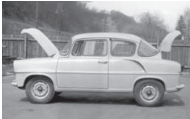
Ve dveřích měl Š 977 malá větrací okénka a pevná větší okna
