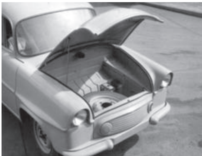
Náhradní kolo bylo u Š 977 uloženo na dně zavazadelníku
