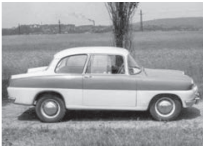
Dvoudveřovou karoserii Š 976 zhotovila Karosa Vysoké Mýto
