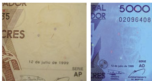
Vlevo jednobarevné konfety a vícebarevná vlákna v bankovní hmotě na bankovce Ekvádoru, vpravo konfety v UV světle (266 nm)
