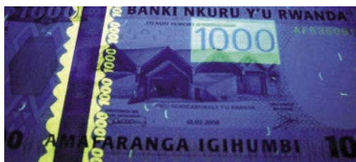
Fluorescenční tisk na bankovce Rwandy detekovaný UV světlem o vlnové délce 266 nm
