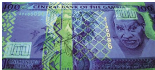
Fluorescenční tisk na bankovce Gambie detekovaný UV světlem o vlnové délce 266 nm
