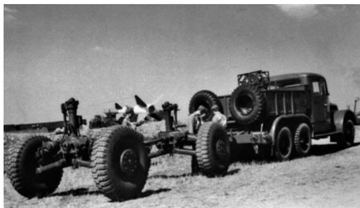
Tatra 141 s podvozky odpalovacího zařízení SM-90, které se po sejmutí odpalovací rampy přesouvaly do sektoru palebné baterie nazývaného postavení vozidel
