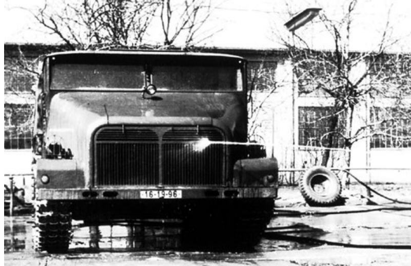
Pásový tahač D-350 Mazur, zkonstruovaný na základě dílů tanku T-54, vyráběný v letech 1959 až 1962, motor dvanáctiválcový vznětový V-54A. Hmotnost 13 500 kg, rozměry d \times \xi \times v = 5810 \times 2900 \times 2700 mm, max. rychlost 53 km/h
