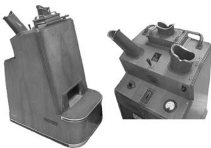
Röntgenový prístroj na nohy, tzv. pedoskop, tak ako ho bolo možné vidieť v obchodoch s obuvou začiatkom sedemdesiatych rokov minulého storočia.
