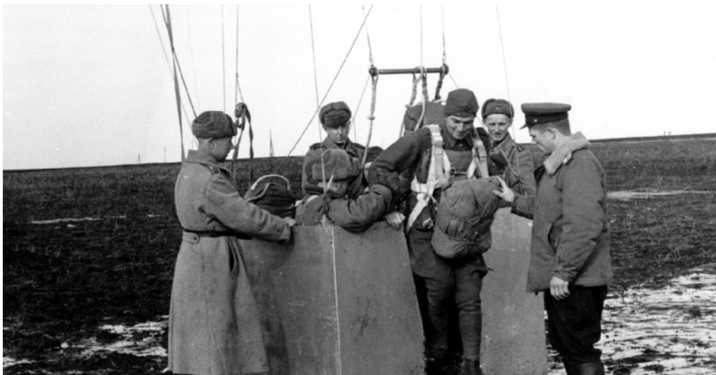
Detailní pohled na standardizovanou gondolu výcvikového balónu, kterou právě „nanečisto“ opouští voj. Ján Ilanovský (dnes generál v.v.) pod dohledem sovětského instruktora npor. Kozlovského. Profil dvířek byl optimalizován pro osobu se dvěma padáky na těle. (sbírka Václav Kameník)
