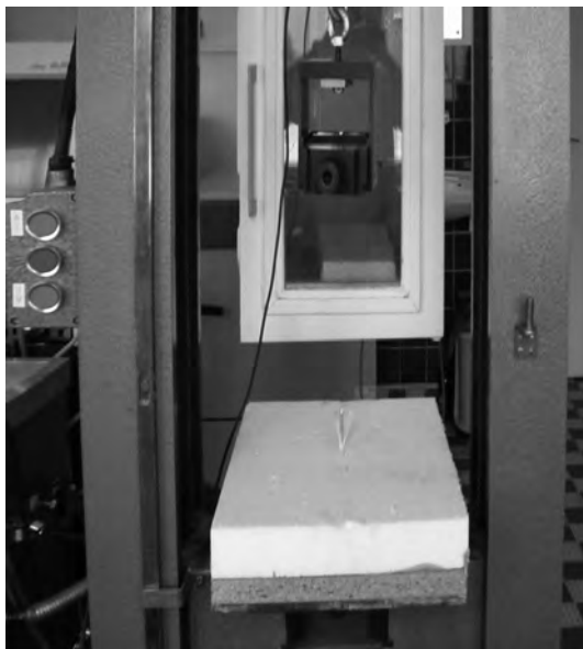
Obr. 11 Zkušební přístroj pro zkoušku protážení hmoždinky izolantem
