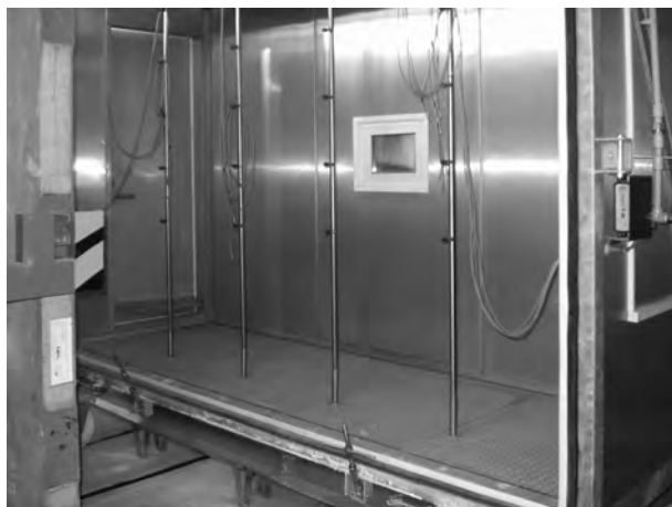
Obr. 2 Zkušební box pro zatěžování klimatickými změnami
