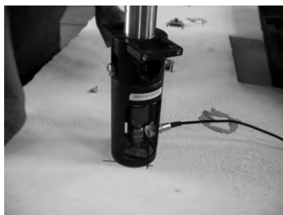
Obr. 7 Odtrh – zkušební přístroj k provede- ní testu
