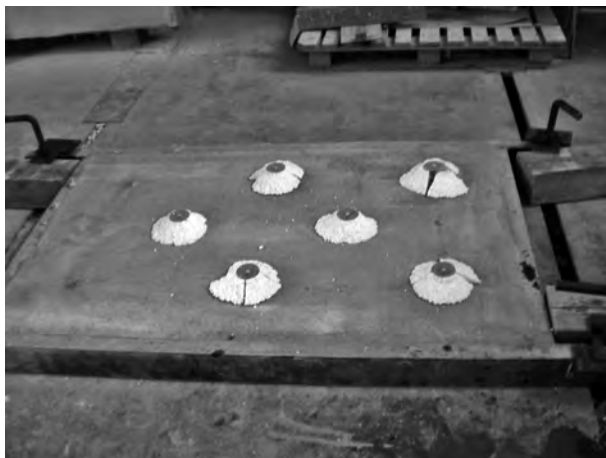
Obr. 10 Pěnový blok – výsledek po odtržení
