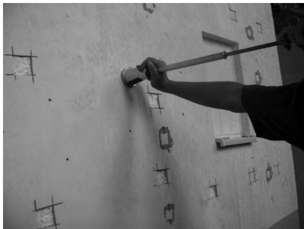
Obr. 5 Vlastní provádění Perfotestu
