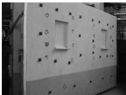
Obr. 6 Odtrh – panel – příprava na odtaho- vé zkoušky
