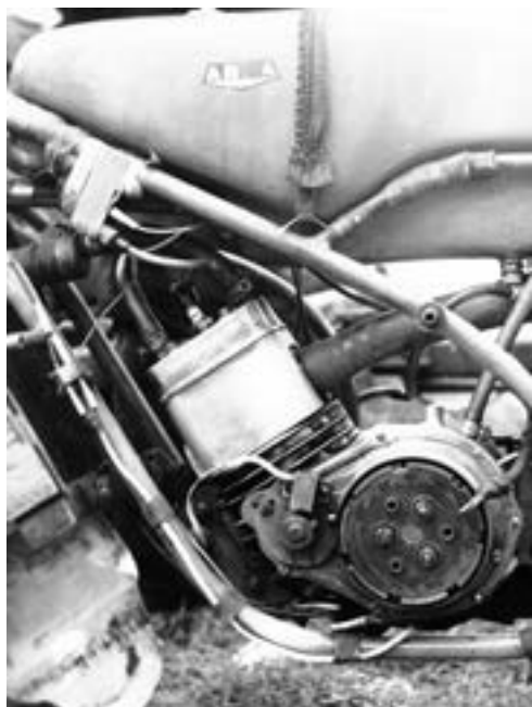
Kapalinou chlazený jednoválec Ahra 125 v detailu
